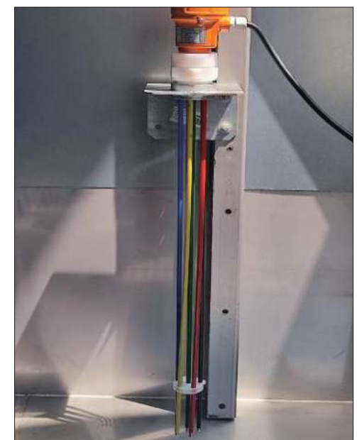
电子水位控制组件
